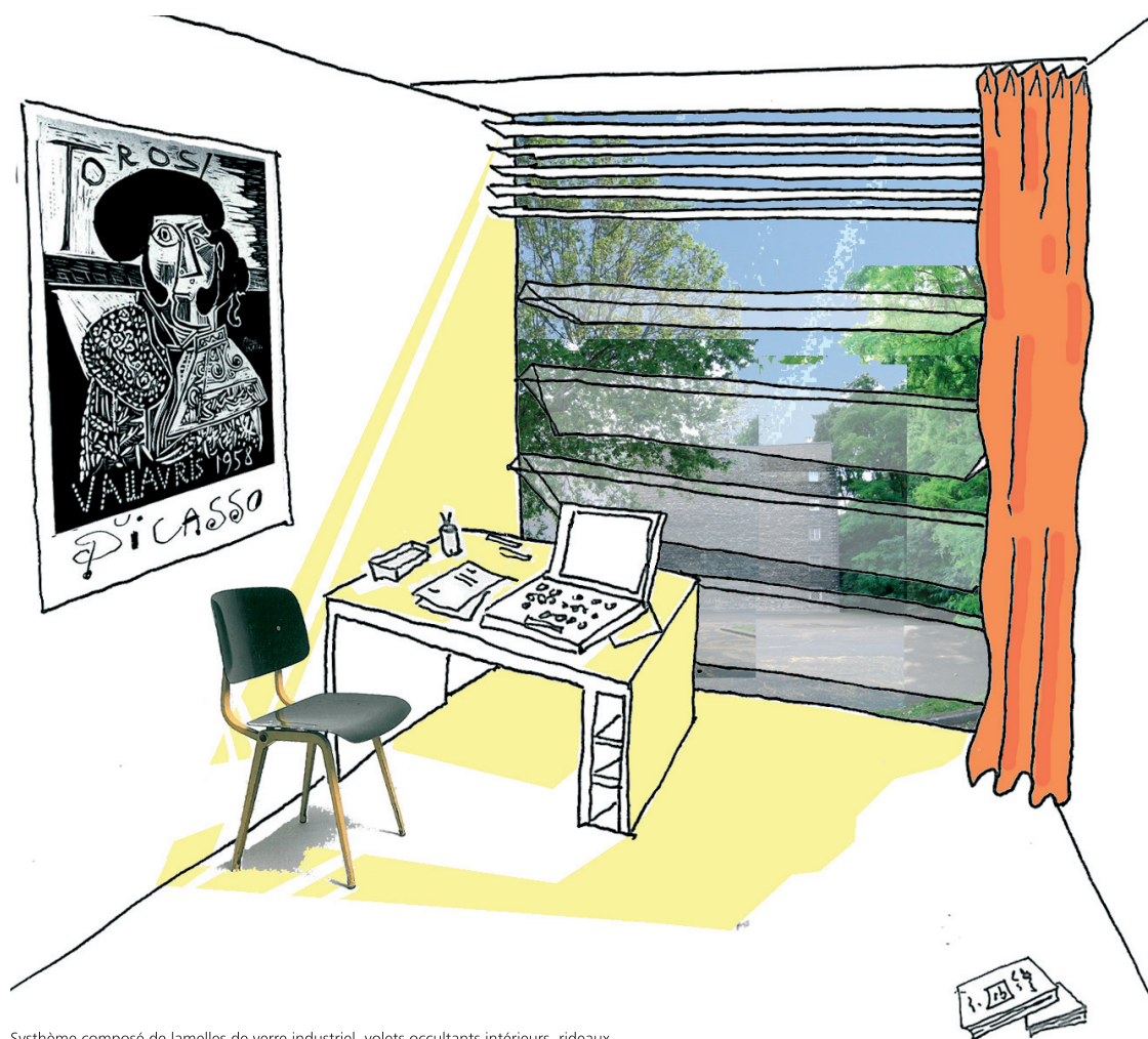
Système composé de lamelles de verre industriel, volets occultants intérieurs, rideaux
